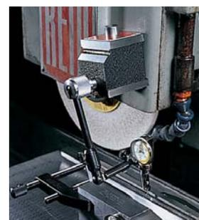
Superior: Base Magnética 657A con Reloj Palpador 196B1 ajustando una pieza en una fresadora
