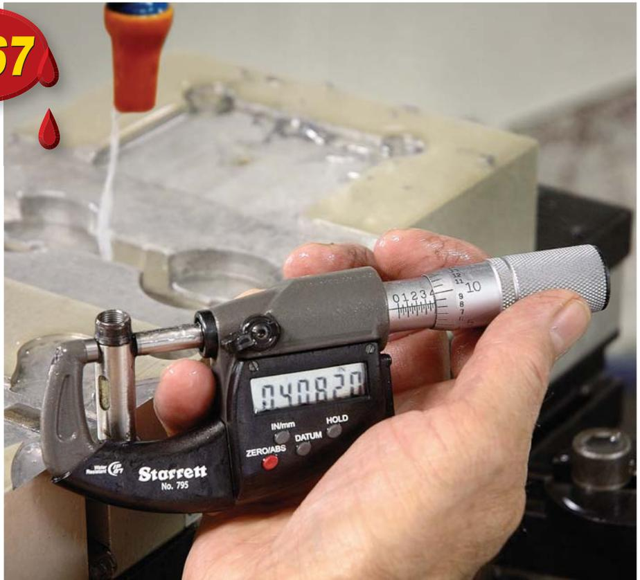
Todos los micrómetros digitales 795 y 796 tienen protección IP67 contra líquidos refrigerantes, agua, partículas y polvo.
