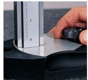
Posicionamiento preciso con el botón de ajuste fino ubicado en la base, que aísla la columna y la corrediza de presiones externas
