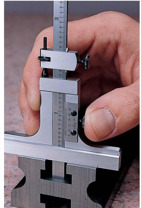
Calibres de Profundidad con resolución de 0,02mm de un lado y 0,001" en el otro
