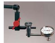
Reloj Palpador 3809MA con fijación tipo "cola de milano"
