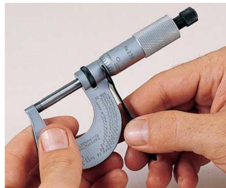
2. Después de limpiar cuidadosamente toda la suciedad o partículas abrasivas de las puntas de contacto fija y del husillo, júntelas y coloque la llave de ajuste en la pequeña ranura del cilindro. En seguida, gire el cilindro hasta que la línea de lectura coincida con la línea del cero del tambor, como muestra la ilustración.
