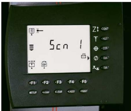
La pantalla LCD interactiva con registro de escaneo único para una visualización fácil de la posición del palpador
