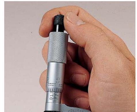
**Carraca** para mediciones consistentes y para acelerar la apertura y el cierre del instrumento.
