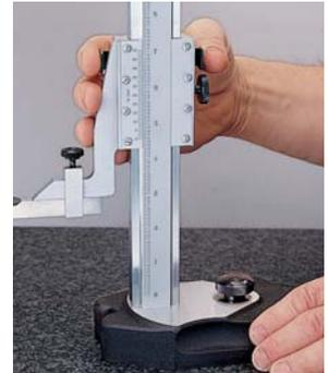
Dispositivo de ajuste rápido, permite acercar la parte corrediza a una medida y posicionarla con precisión, a través del botón de ajuste fino
