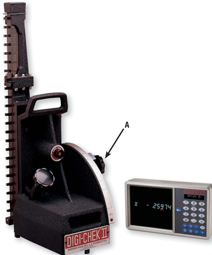
Operación simple de dos pasos, menos de 10 segundos – 1. Ajustar el posicionamiento (A) rápido, dentro de 0,15mm / 0,005" (3 segundos) – 2. Ajuste final (5 segundos).
