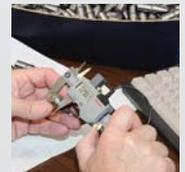
Los métodos 1 y 2 implican movimientos demorados de la mano para sujetar y dejar las herramientas para el registro de los datos mientras que la medición con DataSure es rápida y directa. El método más lento (M1) demanda 29 segundos por pieza ocasionando muchos errores. Con el DataSure la misma tarea fue casi cinco veces más rápida y sin errores.
