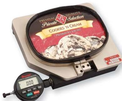
Tapa de un recipiente de helado en la posición de medición
