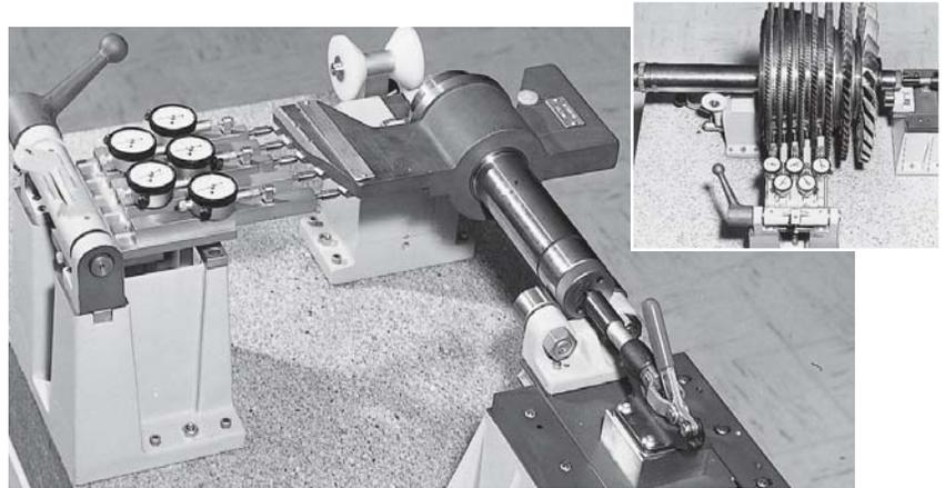
En el detalle: el rotor gira a 360° sobre su eje para determinar los desvíos radiales
