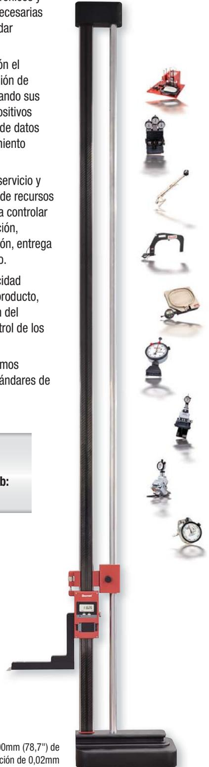
Estándar de altura con 2000mm (78,7") de rango de medición y resolución de 0,02mm
