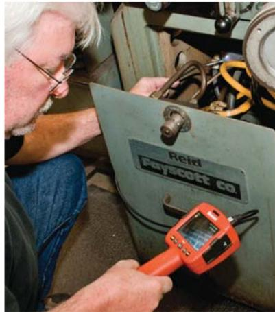
Los video endoscopios industriales de Starrett son ideales para inspeccionar áreas inaccesibles a simple vista.
