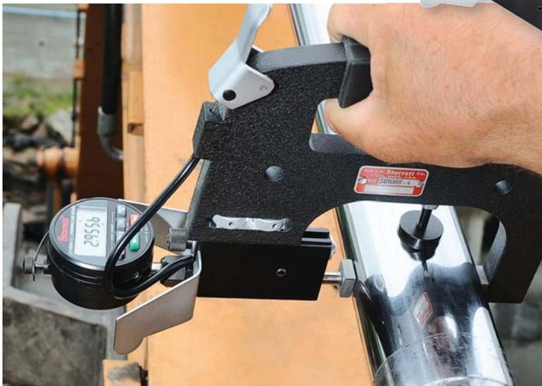
Medición de precisión de un cilindro hidráulico
