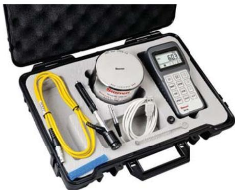
Incluye instrumento base, Dispositivo de impacto D, Bloque estándar de dureza calibrado (específico para esta finalidad), maleta de transporte, cepillo de limpieza y manual de operación
