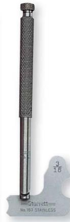
A la izquierda: Juego de Plantillas de Radios N° S167CHZ con 25 piezas y mango, en estuche. Mango N° 110 con N° 167-1/4" acoplado. Abajo: Verificando radio con plantilla y mango.
