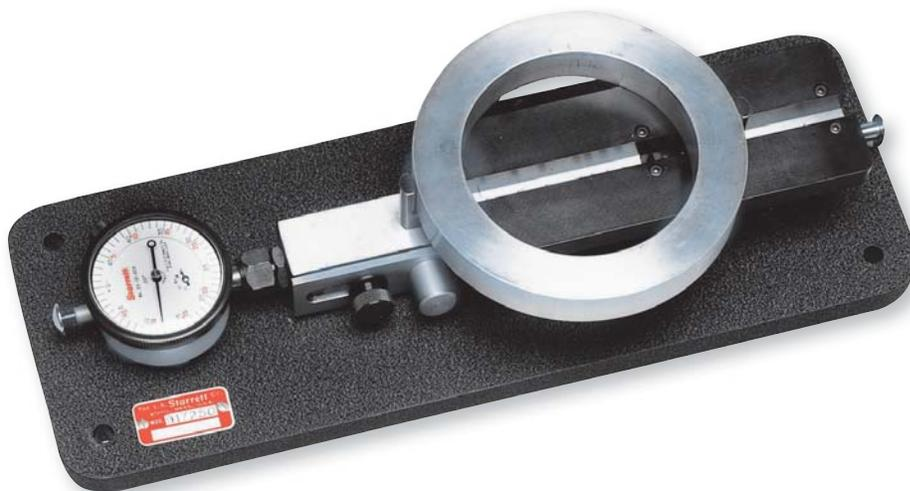
Las puntas de contacto están disponibles para numerosas aplicaciones. Conjuntos opcionales con 2 ó 3 puntas de contacto con caras planas, esféricas o cónicas, de acero o metal duro, o puntas de contacto para medición con rodillos.
