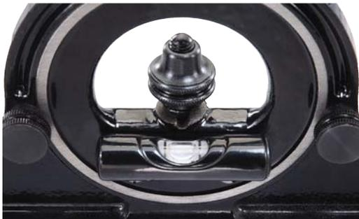
Burbuja de nivel ubicada en la parte trasera del transportador
