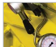
Tensado de la lámina hidráulico
