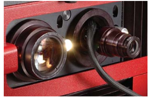
Arriba: OV 2 instalado en un HD400 con una lente de 10X Abajo: Fácil intercambio entre una lente estándar y el video OV 2
