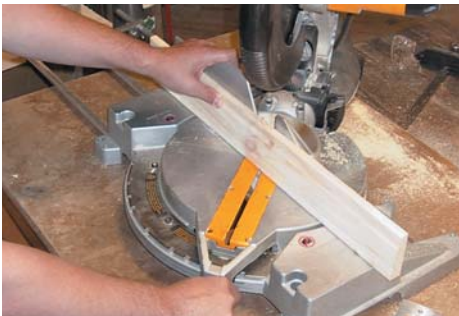
2. Ajuste la sierra al ángulo que la flecha roja indica en la escala roja
