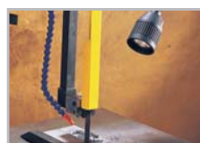
Iluminación en el área de corte
